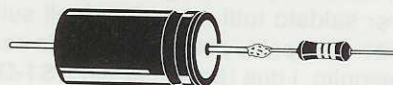
Fig.10 Per verificare se lo strumento legge regolarmente la ESR, collegate in serie al condensatore elettrolitico una resistenza ohmica da 1-10-100 ohm.
