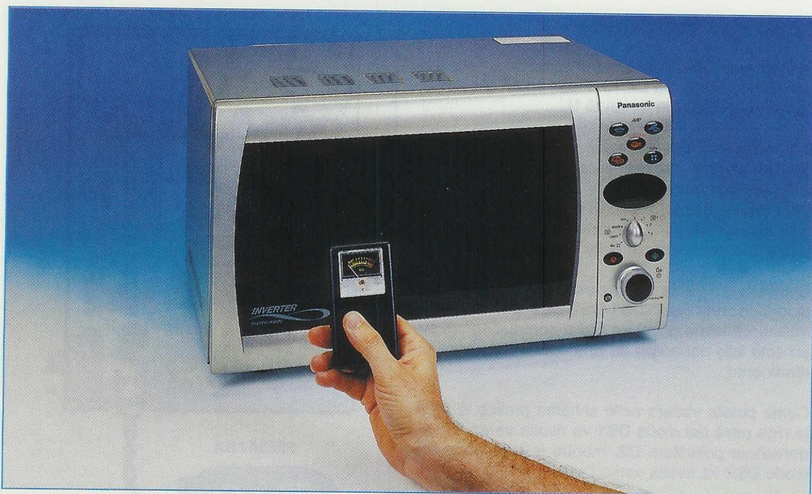
Fig.7 In teoria le onde SHF utilizzate nei Forni a Microonde non dovrebbero mai uscire all'esterno, ma se avvicinate il vostro rivelatore di fughe potrete verificarlo personalmente. Ponendo lo strumento a circa 20 cm dal forno, la sua lancetta non dovrebbe mai deviare verso il fondo scala (a destra). Ponendo lo strumento a 50 cm di distanza dal forno, in assenza di perdite, la sua lancetta rimarrà immobile sul lato sinistro.
