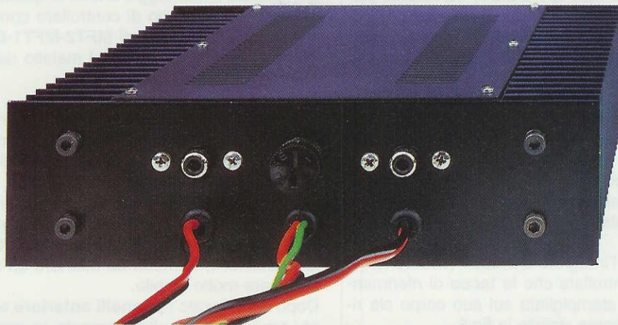
Fig.14 Sul pannello posteriore del mobile metallico fissate le due prese d'ingresso per il segnale BF e il portafusibile (vedi fig.6). Sempre da questo pannello farete uscire i fili che andranno a collegarsi agli Altoparlanti o alle Casse Acustiche e anche quelli per collegarsi ai 12 volt della batteria. Nei fori di passaggio inserite i gommini passafilo.
